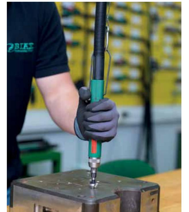
Alle geraden Bohrentgrater können mit einem Federzug betrieben werden.
