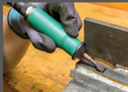
Die Maschinen eignen sich hervorragend zum Nachbearbeiten im 3D Druck, Entfernen von Schweißrückständen und Gravieren.
