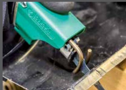
Unsere Druckluftsägen sind besonders geeignet für Trennarbeiten an der Karosserie und im Stahlblech. Auch für andere Materialien wie Aluminium, Buntmetalle, Nichteisenmetalle, Plastik, Holz oder Verbundstoffe führen wir die passenden Sägeblätter im Sortiment. Unsere Druckluftsägen basieren auf den legendären SIG-Sägen und werden an unserem Schweizer Standort in Neuhausen am Rheinfall gefertigt.
