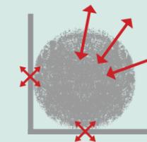
Hat der Frässtift an mehreren Stellen gleichzeitig Kontakt zum Bauteil oder ist die Kontaktfläche des Frässtifts zum Bauteil zu groß, kommt es zu Schlägen und Vibrationen.
